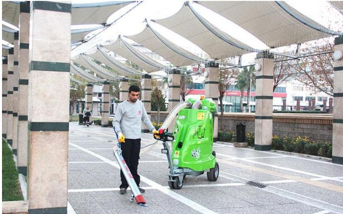
L'aspirateur de déchets ou de voirie est un appareil électrique mobile, très maniable et auto-tracté, destiné pour nettoyer tout type d'espace extérieur ou intérieur et capable d'aspirer tous les types de déchets.
